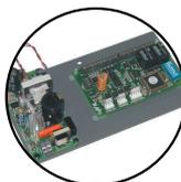
Scheda di controllo a processore opzionale, per una totale integrazione con qualsiasi tipologia di controllo accessi.
