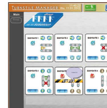
TMON SOFTWARE - software per il controllo di tornelli e varchi / software for remote control of the turnstiles and gates
